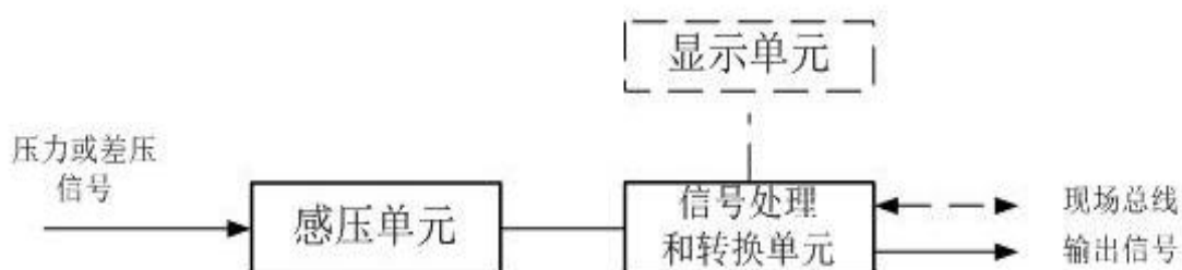
图 1 压力变送器原理框图
